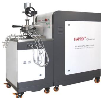
混炼式转矩流变仪
