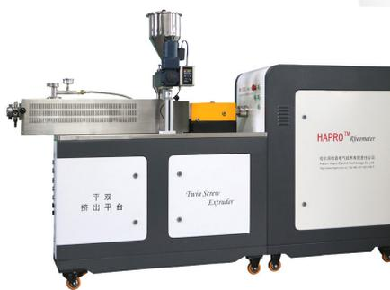
平行双螺杆挤出式转矩流变仪
